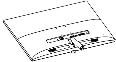
2. Tenere la base con entrambe le mani ed inserire saldamente la base nel supporto.
