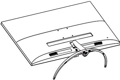
2. (1) Utilice el destornillador para aflojar el tornillo ubicado debajo de la base.
