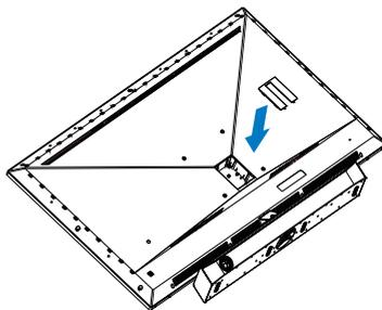
4. Debido al diseño posterior de la pantalla, asegúrese de fijar 4 tuercas espaciadoras (incluidas en la caja) antes de instalar el soporte de montaje en pared. Sobre la tapa de la bisagra.
