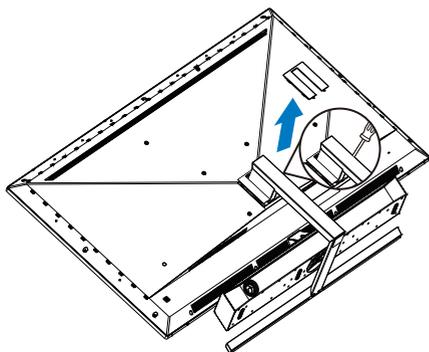
2. Afloje los tornillos del ensamblaje y, a continuación, desmonte las bases de la pantalla.
