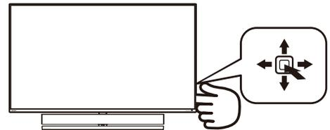
Para acceder al menú OSD de esta pantalla Philips, simplemente tiene que utilizar el botón de cambio único situado en la parte posterior de la pantalla. El botón único opera como un joystick. Para mover el cursor, simplemente accione el botón en
