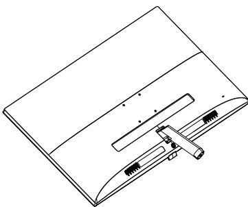
2. 用双手拿住底座支撑臂，用力将底座支撑臂插入底座支撑柱上。
