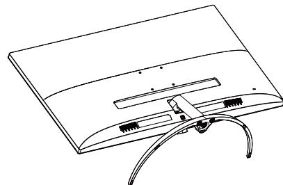
2. (1) 用螺絲刀鬆開底座底部的螺絲。
