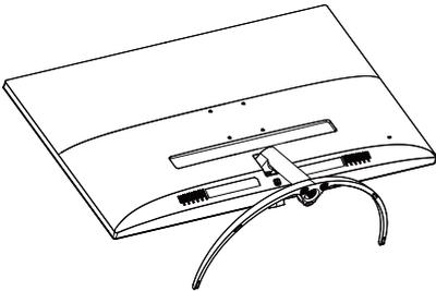
2. (1) Usare il cacciavite per allentare la vite situata nella parte inferiore della base.
