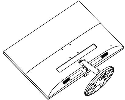
2. (1) Usare il cacciavite per allentare la vite situata nella parte inferiore della base.
