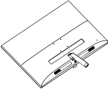
2. Tenere la base con entrambe le mani ed inserire saldamente la base nel supporto.
