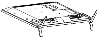
2. Ослабьте установочные винты, а затем отсоедините основание от монитора.
