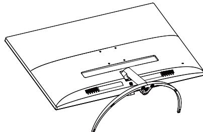
2. (1) Z izvijačem odvijte vijak na dnu ohišja.
