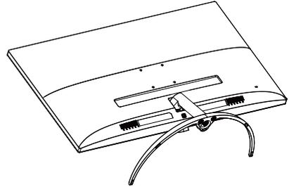
2. (1) Χρησιμοποιήστε κατσαβίδι για να ξεσφίξετε τη βίδα που βρίσκεται στο κάτω μέρος της βάσης.
