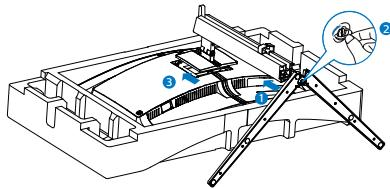
3. Nakon povezivanja postolja, uspravite monitor tako što ćete obema rukama čvrsto držati monitor zajedno sa stiroporom. Sada možete da izvučete stiropor. Kada budete izvlačili stiropor, ne pritiskajte panel da biste izbegli lomljenje panela.
