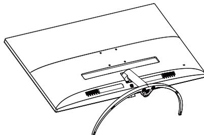
2. (1) Открутите отверткой винт, расположенный в нижней части основания.
