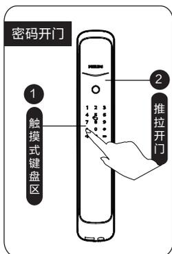
① 触摸数字键区域，点亮数字键。直接输入已经添加的密码，按【#】号键确认；
