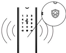
**触发机制:** 门锁处于布防模式时, 从室内开启门锁, 将触发报警
