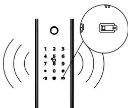
**触发机制:** 当系统唤醒后, 将自动检测电池电压, 当电池电压不足时, 发出警报, 提示您及时更换电池
