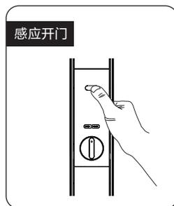
手柄上设计有传感器，在触发红外感应的情况下，手同时握住手柄的前、后触摸感应模块即可解锁。
