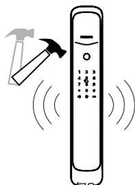
**触发机制1:** 门缝撬开后, 感应锁舌弹出
