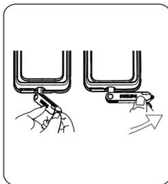
② 把机械钥匙插入锁孔，钥匙套与钥匙成垂直90°，钥匙套向执手方向旋转90°，直至靠近门面。
