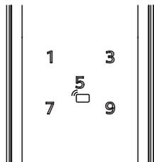
门锁在处于反锁状态下, 外部电子功能锁定。手动唤醒系统时, 键盘区域会显示15937(X), 并语音提示已反锁, 表示已经启动反锁。
