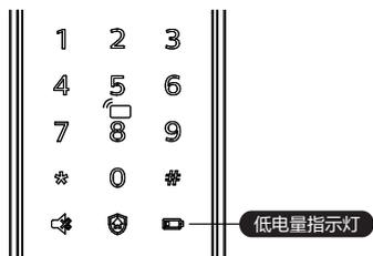
**红色:** 门锁系统唤醒时, 系统自动检测电池电压, 当电池电压过低时, 低电量提示灯亮起, 闪烁红色灯光, 开锁时会有语音提示电量低, 请更换电池。
