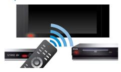
所连接的设备和电视机之间共享功能。借助 EasyLink,您只需要一个遥控器就可以操控电视机和所连接设备的主要功能。 EasyLink 使用标准 HDMI 电缆来传输系统命令。它可以在配备 HDMI CEC 的所有电子设备之间使用。
