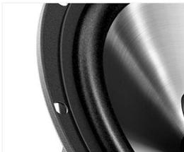
Un tissu extrêmement sensible connecte le diaphragme de haut-parleur de graves au cadre du haut-parleur pour former un système de suspension. Lorsqu'un signal sonore atteint le cône dans le haut-parleur de graves, le tissu replace le cône dans sa position pour recevoir un autre signal sonore. Ce faisant, le haut-parleur de graves peut capturer chaque signal avec une déformation minimum et offre un son limpide et agréable quel que soit le niveau sonore associé à la lecture de la musique.
