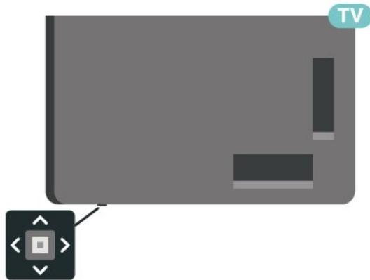
**1** - При включен телевизор натиснете клавиша с джойстик в долната част на телевизора, за да извикате базовото меню.
