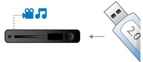
L'USB (Universal Serial Bus) est un protocole permettant de relier facilement des ordinateurs, des périphériques et des équipements électroniques grand public. Les appareils USB ultrarapides ont un taux de transfert de données allant jusqu'à 480 Mbit/s (il était de 12 Mbit/s sur les premiers appareils USB). Avec le port USB 2.0 ultrarapide, vous n'avez qu'à brancher votre appareil USB, sélectionner un film, un titre ou une photo et lancer la lecture.
