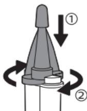
3 Placez l'embout mélangeur sur la seringue et fixez-le en le tournant dans le sens des aiguilles d'une montre. Retirez le protecteur d'embout de l'extrémité de la buse.
