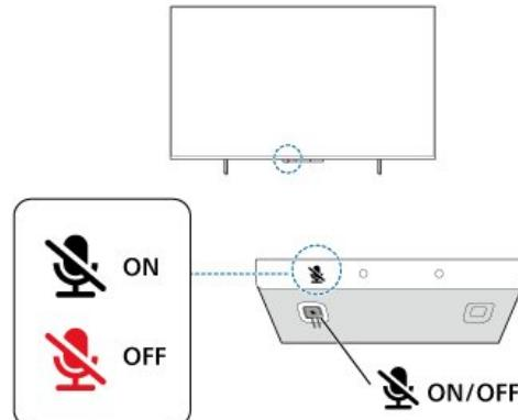
远场麦克风下方有一个开关按钮，您可以按下以打开或关闭麦克风。通常，麦克风处于就绪状态，且 LED 指示灯熄灭。如果按下开关按钮将麦克风关闭，则 LED 指示灯将亮起，以提醒您麦克风未就绪。
