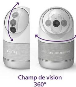
Consegue deslocar-se num eixo horizontal de 355°. O seu ângulo de visão é de 80°. Graças ao motor e à funcionalidade de monitorização automática, a câmara segue a ação. A câmara pode ser fixada ao teto graças ao suporte incluído.
