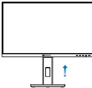
2. Postavite monitor licem naniže na meku površinu. Pazite da izbegnete grebanje i oštećivanje monitora. Potom podignite postolje monitora.
