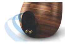
В системе Bass-reflex используется фазоинвертор, настроенный для оптимальной громкости АС, что позволяет воспроизводить глубокие басы при использовании компактного корпуса. Тщательно продуманная специальная конструкция фазоинвертора обеспечивает необходимый поток воздуха и глубокие насыщенные басы даже при высоком уровне громкости, уменьшая при этом турбулентность, которая приводит к искажению.
