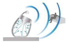
Продуманная изогнутая форма задней панели этой акустической док-станции от Philips позволяет создать высокоэффективную акустическую конструкцию для передачи звука. Изгиб усиливает жесткость корпуса АС, значительно снижая внутренний резонанс и повышая точность и естественность звучания. Вы будете в восторге от потрясающего звука этих стильных акустических систем.
