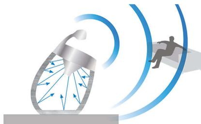
Продуманная изогнутая форма задней панели этой акустической док-станции от Philips позволяет создать высокоэффективную акустическую конструкцию для передачи звука. Изгиб усиливает жесткость корпуса АС, значительно снижая внутренний резонанс и повышая точность и естественность звучания. Вы будете в восторге от потрясающего звука этих стильных акустических систем.
