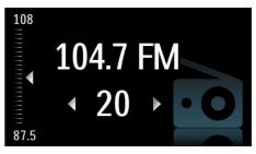
Просто настройте необходимую станцию, а затем нажмите и удерживайте кнопку Preset (Предустановка), чтобы сохранить частоту. Благодаря функции сохранения предустановленных радиостанций можно быстро получить доступ к любимой радиостанции, не настраивая ее вручную каждый раз.
