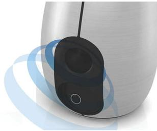
В системе Bass-reflex используется фазоинвертор, настроенный для оптимальной громкости АС, что позволяет воспроизводить глубокие басы при использовании компактного корпуса. Тщательно продуманная специальная конструкция фазоинвертора обеспечивает необходимый поток воздуха и глубокие насыщенные басы даже при высоком уровне громкости, уменьшая при этом турбулентность, которая приводит к искажению.
