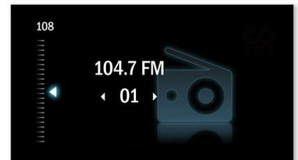
Аудиосистема Philips оснащена цифровым FM-тюнером, что открывает дополнительные возможности для прослушивания музыки. Просто настройте любимую станцию, а затем нажмите и удерживайте кнопку предустановки для запоминания частоты. Благодаря функции сохранения предустановленных радиостанций можно быстро получить доступ к любимой радиостанции, не настраивая ее вручную каждый раз.
