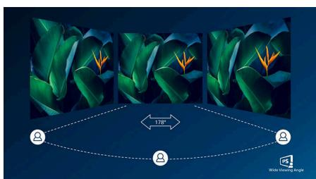
Os ecrãs IPS utilizam uma tecnologia avançada que lhe proporciona ângulos de visualização extra amplos de 178/178 graus, o que permite ver o ecrã a partir de praticamente qualquer ângulo. Ao contrário dos painéis TN padrão, os ecrãs IPS fornecem-lhe imagens incrivelmente
