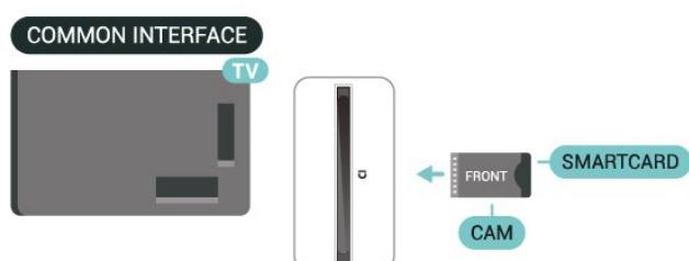
當您開啟電視時，CAM 需要幾分鐘才能啟動。若已插入 CAM 且已支付訂閱費用 (有多種不同的訂閱方式)，您可以觀賞 CAM 智慧卡支援的加密頻道。
