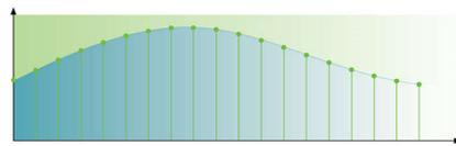
Un échantillonnage à 192 kHz permet d'obtenir une représentation précise des courbes sonores d'origine. Outre une résolution 24 bits, davantage d'informations de l'onde sonore analogique d'origine sont capturées, fournissant ainsi une reproduction audio de meilleure qualité.
