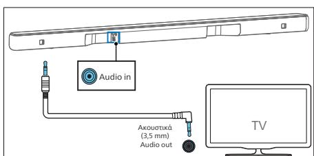
Χρησιμοποιήστε ένα καλώδιο ήχου 3,5 mm-RCA
