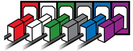
Les connecteurs de couleur facilitent la connexion des enceintes et des caissons de basses à l'unité centrale du système Home Cinéma. Branchez simplement les câbles aux connecteurs de même couleur à l'arrière de l'unité.
