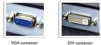
La double entrée prévoit des connecteurs permettant l'entrée de signaux analogiques VGA et de signaux numériques DVI.
