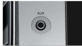
Conexión de entrada auxiliar para reproductor MP3 portátil
