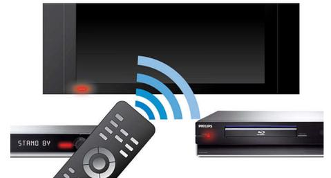
EasyLink te permite controlar varios dispositivos con un solo control remoto y utiliza el protocolo estándar HDMI CEC para que los dispositivos conectados compartan las mismas funciones a través de un cable HDMI. Con sólo presionar un botón, podés controlar todos los equipos HDMI CEC de forma simultánea y las funciones de modo de espera y de reproducción son muy fáciles de usar.
