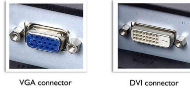
La doble entrada proporciona conectores para entrada de señales VGA analógicas y DVI digitales.
