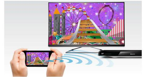
Miracast™ es un estándar inalámbrico de presentación en pantalla entre usuarios creado a través de conexiones Wi-Fi. La interfaz de usuario simplificada duplica la pantalla del dispositivo portátil en una pantalla más grande mediante un dispositivo con Miracast™, sin límites de códecs incorporados para decodificación.
