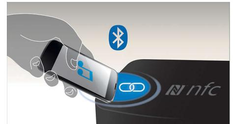
Sincroniza fácilmente los dispositivos Bluetooth con la tecnología NFC (Near Field Communications) con un solo toque. Solo toca el smartphone o la tablet compatible en el área NFC de un parlante para encenderlo, iniciar la sincronización con Bluetooth y comenzar a transmitir música.
