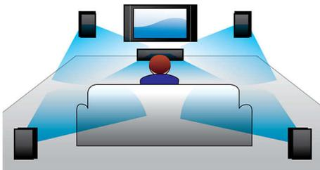
La integración del sistema decodificador Dolby Digital elimina la necesidad de utilizar un decodificador externo. Este decodificador procesa los seis canales de información de audio para proporcionar un sonido envolvente, una sensación increíblemente natural y un gran dinamismo. Dolby Pro Logic II ofrece cinco canales de procesamiento envolvente a partir de cualquier fuente estéreo.
