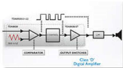
El amplificador digital clase «D» toma una señal analógica, la convierte en digital y luego amplifica digitalmente la señal, que pasa a continuación por un filtro de demodulación antes de transferirse como señal de salida final. La salida digital amplificada ofrece todas las ventajas del audio digital, incluso con mejor calidad acústica. Además, demuestra una eficacia 90% superior a la de los amplificadores AB convencionales. Esta eficacia se traduce en un amplificador potente y compacto.
