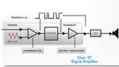
El amplificador digital clase «D» toma una señal analógica, la convierte en digital y luego amplifica digitalmente la señal, que pasa a continuación por un filtro de demodulación antes de transferirse como señal de salida final. La salida digital amplificada ofrece todas las ventajas del audio digital, incluso con mejor calidad acústica. Además, demuestra una eficacia 90% superior a la de los amplificadores AB convencionales. Esta eficacia se traduce en un amplificador potente y compacto.
