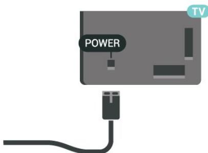
Αν και η τηλεόραση αυτή καταναλώνει ελάχιστο ρεύμα στην κατάσταση αναμονής, για εξοικονόμηση ενέργειας, συνιστάται να αποσυνδέετε το καλώδιο ρεύματος, αν δεν σκοπεύετε να χρησιμοποιήσετε την τηλεόραση για μεγάλο χρονικό διάστημα.
