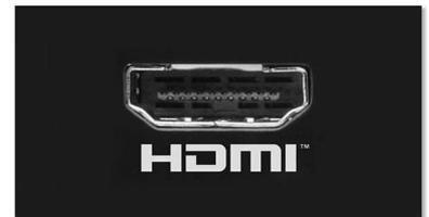
Über HDMI werden digitale HD-Videosignale und digitale Mehrkanal-Audiosignale direkt und digital übertragen. Weil keine Umwandlung auf Analogsignale mehr erforderlich ist, liefert HDMI perfekte Bild- und Tonqualität ohne jedes Rauschen. HDMI ist komplett rückwärtskompatibel mit DVI.
