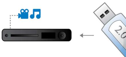
Der universelle serielle Bus, kurz USB genannt, ist ein Standardprotokoll für den problemlosen Anschluss von PCs, Peripheriegeräten und Unterhaltungselektronik. High-Speed USB-Geräte haben eine Datenübertragungsrate von bis zu 480 Mbit/s, im Gegensatz zu den 12 Mbit/s des ursprünglichen USB-Standards. Mit der High-Speed USB 2.0-Verbindung müssen Sie lediglich Ihr USB-Gerät anschließen, den Film, den Musiktitel oder das Foto auswählen und die Wiedergabe starten.
