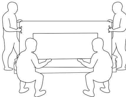
6. 小心地移动显示器，直至底部手柄脱离包装箱。两侧的两个人应抓住 4 个手柄，而另两个人则站在显示器的正面和背面以支撑底部。
