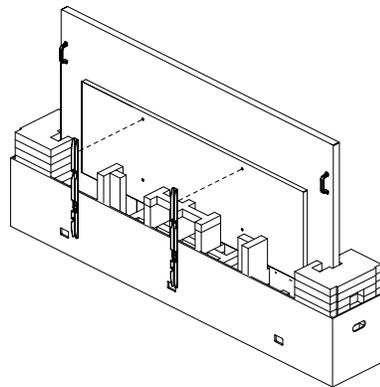
5. 两侧的两个人应抓住显示器背面的顶部手柄，而另两个人则帮助从底部抓住显示器。
