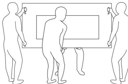
7. 最初位于显示器背面的人员应移至前面，以便所有四个人可以将显示器安装到墙壁上。
