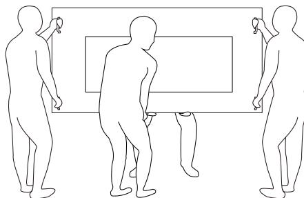
7. 最初位於顯示器背面的人應移動至正面，讓四人能一起將顯示器安裝到牆上。
