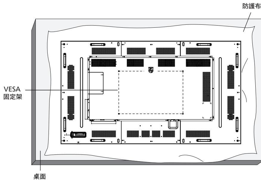
1. 顯示器擺放在平坦表面上時展開包覆顯示器的防護布。讓顯示器正面朝下放置在防護布上，以協助您操作而不會刮傷螢幕。
