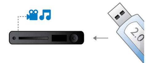
Il sistema Universal Serial Bus, o USB, è un protocollo standard che viene utilizzato per collegare semplicemente PC, periferiche e apparecchi elettrici. Le periferiche USB ad alta velocità consentono una velocità massima di trasferimento di 480 Mbps, rispetto ai 12 Mbps dei vecchi dispositivi USB. Grazie al collegamento Hi-Speed USB 2.0, basta collegare la tua periferica USB, selezionare il film, il file musicale o la foto e iniziare subito la riproduzione.
