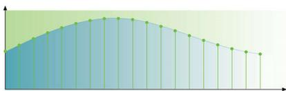
La frequenza di campionamento 192 kHz fornisce una rappresentazione accurata delle curve dell'audio originale. Insieme a una risoluzione a 24 bit, vengono acquisite ulteriori informazioni dalla forma dell'onda dell'audio
