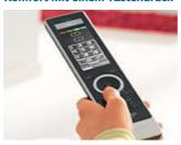
Die Bedienung per Tastendruck ermöglicht Ihnen, mehrere Befehle mit einem Knopfdruck über ein Makro auszuführen. Bei einem Makro wurde eine Folge an vorprogrammierten Befehlen in der Bedienung einer Taste zusammengefasst. Daher kann durch einfaches Drücken einer Taste eine ganze Reihe an Befehlen ausgeführt werden.
