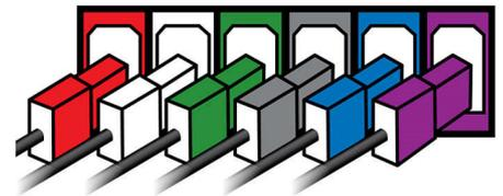
Farbkodierte Anschlüsse erleichtern das Anschließen der Lautsprecher und des Subwoofers an das Home Entertainment-System, da die Stecker lediglich in die entsprechenden farblich markierten Buchsen auf der Rückseite eingesteckt werden müssen.
