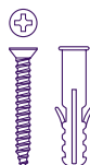
7. Parafusos (x4) e buchas (x4) para montagem na parede do painel da rua e do monitor
