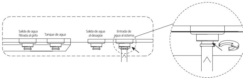
Nota: La presión del agua de entrada debe estar entre 0,3 y 0,7 MPa. Si la presión es demasiado baja, se debe instalar un reforzador de presión antes del sistema.
