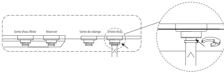
Remarque : la pression d'eau en entrée doit être comprise entre 0,3 et 0,7 MPa (3 et 7 bar).
