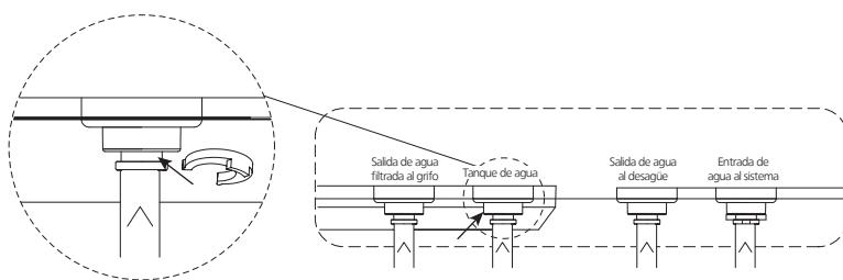
Coloque el cabezal y el depósito de agua en un área adecuada como se indica a continuación. A continuación, instale la cubierta en el colector.
