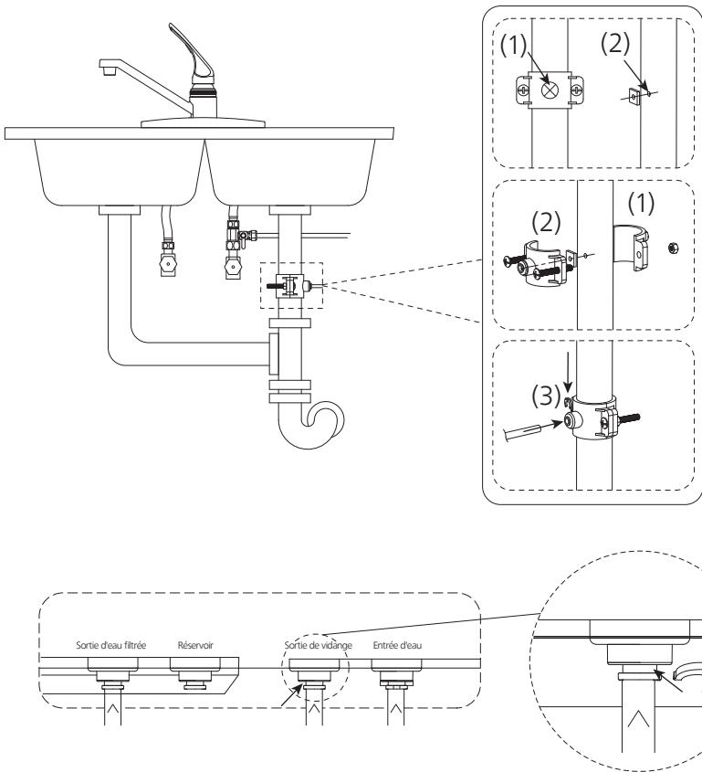
Remarque : la pression d'eau en entrée doit être comprise entre 0,3 et 0,7 MPa (3 et 7 bar).
