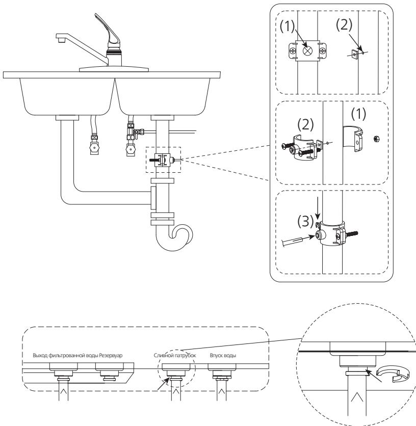
Примечание: Давление воды на входе должно быть в пределах 0,3-0,7 МПа. Если давление слишком низкое, перед системой следует установить усилитель давления. Если давление слишком высокое, перед системой следует установить клапан избыточного давления.
