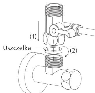
d. Połącz wąż zimnej wody z trójdrożnym zaworem kulowym i mocno przykręć go kluczem. Podczas instalacji nie zapomnij o uszczelce wewnętrznej węża zimnej wody.
