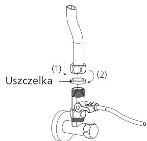
e. Zakręć trójdrożny zawór kulowy. Odkręć dopływ zimnej wody. Przetrzyj połączenia chusteczką, aby sprawdzić, czy nie ma wycieków. Jeśli chusteczka pozostaje sucha, oznacza to, że zawór trójdrożny jest zainstalowany prawidłowo.
