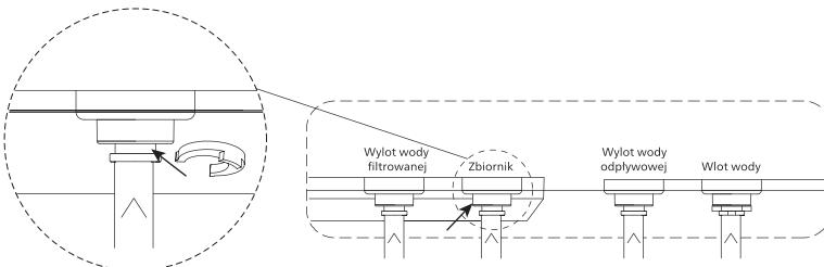
Umieść kolektor i zbiornik na wodę w odpowiednim miejscu w sposób pokazany poniżej. Następnie zainstaluj pokrywę na kolektorze.
