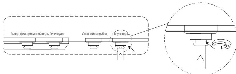
Примечание: Давление воды на входе должно быть в пределах 0,3-0,7 МПа. Если давление слишком низкое, перед системой следует установить усилитель давления. Если давление слишком высокое, перед системой следует установить клапан избыточного давления.
