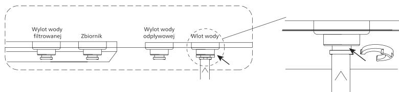
Uwaga: Ciśnienie wody na wejściu powinno mieścić się w zakresie 0,3–0,7 MPa. Gdy ciśnienie jest zbyt niskie, przed systemem należy zainstalować wzmacniacz ciśnienia. Gdy ciśnienie jest za wysokie, przed systemem należy zainstalować zawór bezpieczeństwa.
