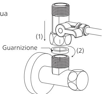
d. Collegare il tubo dell'acqua fredda con la valvola a sfera a tre vie e avvitare serrando con una chiave.
