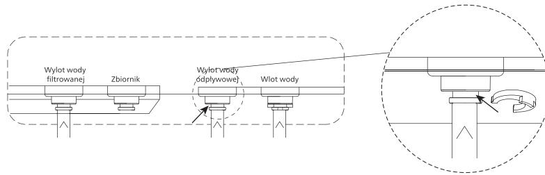
Uwaga: Ciśnienie wody na wejściu powinno mieścić się w zakresie 0,3–0,7 MPa. Gdy ciśnienie jest zbyt niskie, przed systemem należy zainstalować wzmacniacz ciśnienia. Gdy ciśnienie jest za wysokie, przed systemem należy zainstalować zawór bezpieczeństwa.
