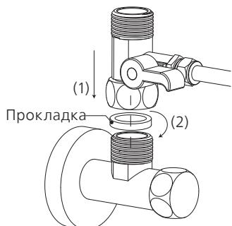
д. Соедините шланг холодной воды с трехходовым шаровым краном и плотно закрутите гаечным ключом.
