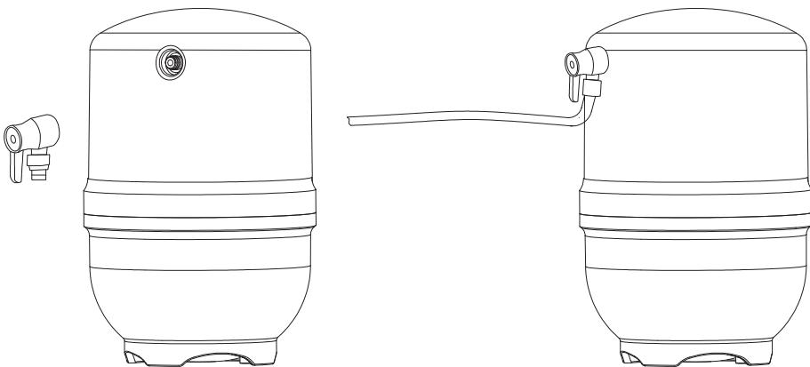
**8. Vérifiez si le dispositif est correctement installé, et ouvrez la vanne 3 voies à boisseau sphérique**
