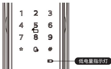
**红色:** 门锁系统唤醒时, 系统自动检测电池电压, 当电池电压过低时, 低电量提示灯亮起, 闪烁红色灯光, 开锁时会有语音提示电量低, 请更换电池。
