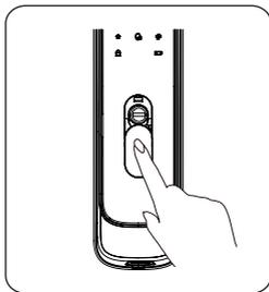
② 按下前面板机械钥匙盖下部，旋转机械钥匙盖下部，并露出钥匙孔。
