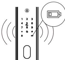
**触发机制:** 当系统唤醒后，将自动检测电池电压，当电池电压不足时，发出警报，提示您及时更换电池
