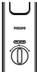
在智能锁处于已上锁状态时，下压并扭动旋钮至左边或右边的上锁刻度处（如左图所示），启用室内反锁。反之，扭动旋钮至中间的开锁刻度处，解除室内反锁。
