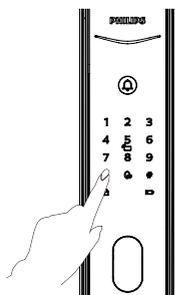
当门锁自动上锁功能偶发故障，不能自动上锁时。关门后，请按门锁面板上的上锁键完成上锁。
