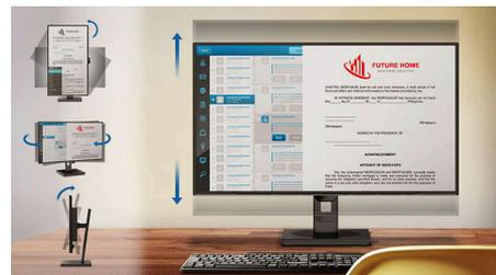
SmartErgoBase è una base per monitor che offre un comfort di visualizzazione ergonomico e un sistema di gestione dei cavi. La base può essere girata, inclinata e ruotata in varie angolazioni per garantire il massimo comfort. Il supporto ad altezza regolabile garantisce una visuale ottimale, riducendo le tensioni di una lunga giornata lavorativa, mentre il sistema di gestione dei cavi evita l'aggrovigliamento degli stessi e mantiene la postazione di lavoro in ordine.
